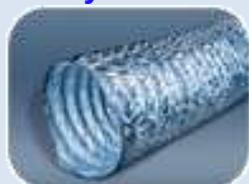
**DF** – гибкие воздуховоды, выполненные из многослойной полиэфирной металлизированной ленты, со спиральным каркасом из стальной проволоки. Рабочая температура от -30°C до +90°C. Максимальное давление 2400 Па. Стандартная длина воздуховода 10 м.
