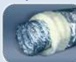
**SonoDF-S** – гибкие звукопоглощающие воздуховоды с перфорированной основой DF, стандартной теплоизоляцией толщиной 25 мм и пароизоляцией из прозрачной полиэфирной ленты. Защитный рукав выполнен из многослойной полиэфирной металлизированной ленты. Рабочая температура от -30°C до +90°C. Максимальное давление 2400 Па. Стандартная длина воздуховода 10 м.
