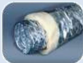
**ISODFA-H** – гибкие теплоизолированные воздуховоды с основой DFA и стандартной теплоизоляцией толщиной 25мм. Защитный рукав выполнен из алюминиево-полиэфирной ленты повышенной толщины с армированием лавсановой сеткой. Обладают повышенной прочностью и износостойкостью. Рабочая температура от -30°C до +120°C. Максимальное давление 3000 Па. Стандартная длина воздуховода 10 м.
