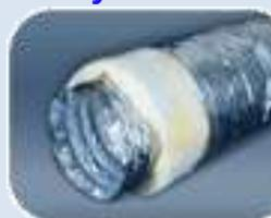
**ISODF** – гибкие теплоизолированные воздуховоды с основой DF и стандартной теплоизоляцией толщиной 25 мм. Защитный рукав выполнен из многослойной полиэфирной металлизированной ленты. Рабочая температура от -30°C до +90°C. Максимальное давление 2400 Па. Стандартная длина воздуховода 10 м.
