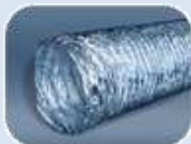
**DFA-H** – гибкие воздуховоды, выполненные из пятислойной алюминиево-полиэфирной ленты повышенной толщины, со спиральным каркасом из стальной проволоки. Обладают повышенной прочностью и износостойкостью. Рабочая температура от -30°C до +120°C. Максимальное давление 3000 Па. Стандартная длина воздуховода 10 м.
