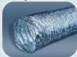
**DFA** – гибкие воздуховоды выполненные из алюминиевой фольги, ламинированной полиэфирной лентой, со спиральным каркасом из стальной проволоки.
