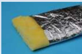
**ISO-F** — гибкая теплоизоляция для воздуховодов из оцинкованной стали прямошовных и спирально-навивных, состоит из слоя стекловаты толщиной 25 мм и защитного жакета из алюминиево-полиэфирной ленты повышенной толщины.
