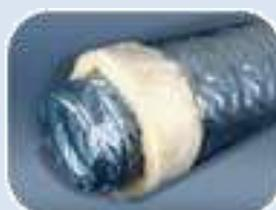
**SonoDFA-H** – гибкие звукопоглощающие воздуховоды с перфорированной основой DFA, стандартной теплоизоляцией толщиной 25мм и пароизоляцией из прозрачной полиэфирной ленты. Защитный рукав выполнен из алюминиево-полиэфирной ленты повышенной толщины с армированием лавсановой сеткой. Обладают повышенной прочностью и износостойкостью. Рабочая температура от -30°C до +120°C. Максимальное давление 3000 Па. Стандартная длина воздуховода 10 м.
