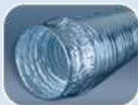
**SonoDFA-SH** - гибкие шумоглушители с перфорированной основой DFA, стандартной теплоизоляцией толщиной 25мм и пароизоляцией из прозрачной полиэфирной ленты. Защитный рукав выполнен из алюминиевой фольги, ламинированной полиэфирной лентой, на спиральном каркасе из стальной проволоки.
