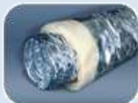
**ISODFA** – гибкие теплоизолированные воздуховоды с основой DFA и стандартной теплоизоляцией толщиной 25мм. Защитный рукав выполнен из многослойной металлизированной ленты, армированной лавсановой сеткой.
