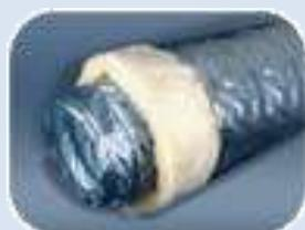
**SonoDFA-S** – гибкие звукопоглощающие воздуховоды с перфорированной основой DFA, стандартной теплоизоляцией толщиной 25мм и пароизоляцией из прозрачной полиэфирной ленты. Защитный рукав выполнен из многослойной металлизированной ленты, армированной лавсановой сеткой.
